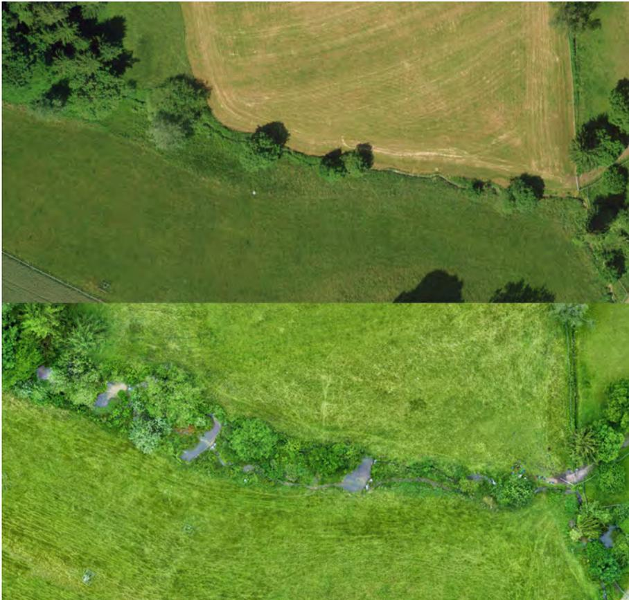
Abb. 3: Der Schlossbach vor (oben) und nach dem Einbau von sechs Beaver Dam Analogs (unten). Bildquelle: swisstopo, D. Tinner.
